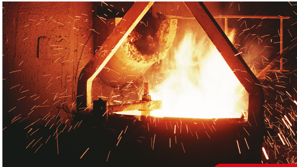
Licí pánev na ocel se zvýšenou kapacitou při použití PROMALIGHT®, tloušťka 5 mm
